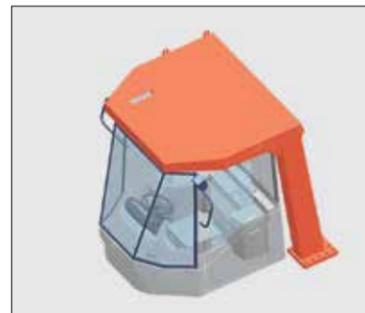
Наружные конструкции ROPS/FOPS защищают оператора от травм в аварийных ситуациях.
