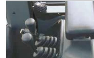
Этот переключатель расположен рядом с рычагами управления для быстрой смены направлений движения. Благодаря такому расположению оператору не требуется убирать руку с рулевого колеса.
