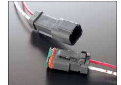
Все соединения в электрической системе выполнены с использованием герметичных разъемов типа Deutsch DT, которые позволяют уменьшить коррозию проводников и гарантировать надежный контакт.
