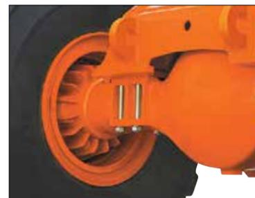
Наружные герметичные дисковые тормоза мокрого типа развивают значительное тормозное усилие и отлично противостоят загрязнениям. Два независимых контура для тормозов переднего и заднего мостов повышают уровень безопасности при эксплуатации машины.
