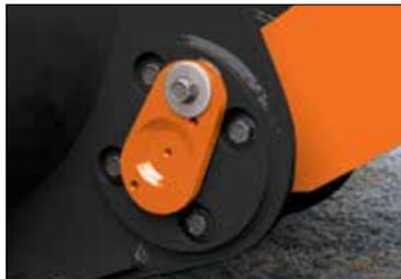
Благодаря герметичным уплотнениям пальцев шарниров ковша консистентная смазка удерживается внутри в течение более длительного промежутка времени.
