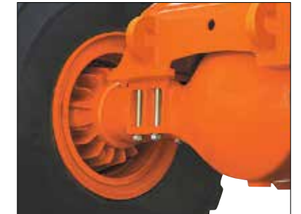
Дисковые тормоза мокрого типа на ступицах колес
