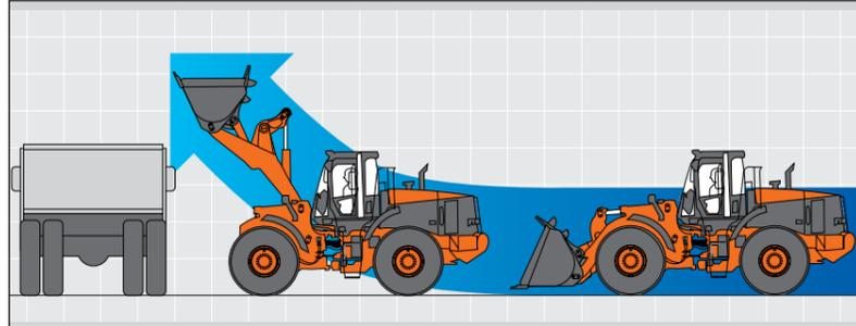
Для увеличения производительности погрузочно-разгрузочных и транспортных работ, подъем ковша осуществляется при одновременном движении. На колесных погрузчиках серии ZW совмещение операций подъема ковша и движения улучшено на 10%, что обеспечивает эффективность погрузочно-разгрузочных работ и увеличение производительности.
