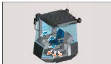
Двухуровневый кондиционер предоставляет возможность одновременного кондиционирования воздуха в области ног и головы. Направление и объем воздушного потока могут быть настроены автоматически, в зависимости от установленной температуры. Герметичная кабина препятствует проникновению пыли и строительного мусора при работе в сложных условиях.
