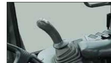
Для удобства использования, многофункциональный джойстик расположен в верхней части рычага управления.
