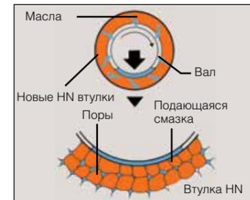
Конструкция втулки HN – это еще один пример новой технологии, разработанной Hitachi, которая обладает высокой надежностью и длительным сроком службы. Масло высокой вязкости закачено под действием вакуума в металл высокой твердости, спеченный из порошка. Во время работы масло медленно проникает из пор втулки в пространство между валом и втулкой, тем самым обеспечивая смазку.
