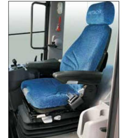
Сиденье с механической подвеской хорошо поглощает ударные нагрузки и вибрации, передаваемые от кузова машины, снижая физические нагрузки на оператора и повышая его комфорт.
