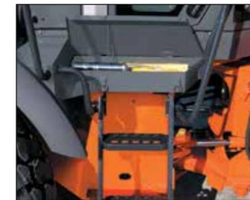
Вместительный ящик для инструментов расположен у верхней ступеньки лестницы на правой стороне погрузчика. В нем может храниться инструмент и шприц для консистентной смазки.
