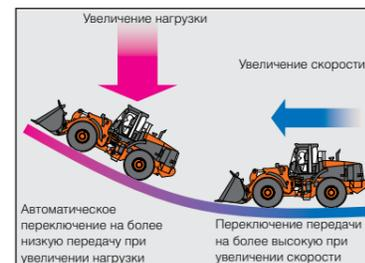
Оптимальное время для переключения передач выбирается в автоматическом режиме в зависимости от скорости и нагрузки.
