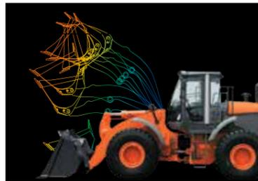
Применение параллельных и тандемных контуров гидравлической системы позволяет управлять рукоятью погрузчика и его ковшом одновременно, в отличие от традиционных машин. Это может значительно увеличить эффективность экскаваторных и погрузочных работ, тем самым повышая производительность.
