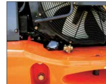
Горловина топливного бака имеет удобное месторасположение, позволяющее вести заправку топлива с земли.
