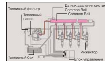
В данной системе впрыска топлива один топливный насос генерирует высокое давление, обеспечивая распределение топлива между форсунками для непосредственного впрыска. Электронный блок управления регулирует время и количество подаваемого топлива для его эффективного сгорания и обеспечения высокой мощности работы двигателя. Данная система снижает выброс PM\* (дизельный шлейф), расход топлива и вибрацию.
