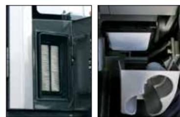
Воздушный фильтр может быть с легкостью заменен из кабины, также как и фильтр системы рециркуляции воздуха, который расположен под подстаканником.
