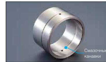
HN-втулки, содержащие масло высокой вязкости, расположены в местах соединений для снижения потребления консистентной смазки, что увеличивает интервалы смазки (с 100 до 500 часов) и повышают долговечность.
