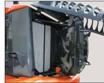
Для обеспечения защиты от коррозии, радиатор и маслоохладитель изготовлены из алюминия, вместо традиционных стали или меди.
