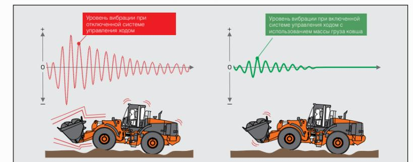
Система управления ходом снижает вертикальное и горизонтальное раскачивание машины при движении по неровной местности или заснеженной дороге посредством автоматического управления положением рабочего оборудования. Ударная нагрузка и вибрация могут быть заметно снижены, обеспечивая комфорт при движении.
