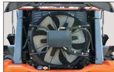
Вентилятор системы охлаждения полностью закрыт металлической сеткой для защиты техника по обслуживанию от случайного ранения при ремонте и техническом обслуживании.
