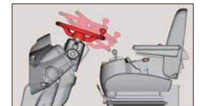
Оператор любой комплектации может подстроить под себя положение регулируемой рулевой колонки, чтобы обеспечить комфорт при работе.
