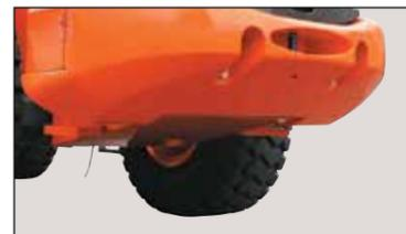
Большой противовес установлен так, чтобы обеспечить защиту топливного бака от повреждения при столкновении с различными препятствиями во время работы.
