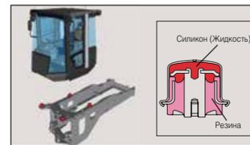
Кабина установлена на специальных гидроэластичных опорах, которые поглощают удары и вибрацию и снижают резонансные колебания.
