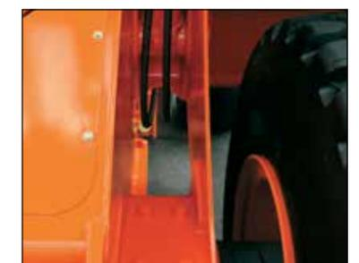
Грязезащищенная (DL) передняя полурама имеет специальную форму для легкого удаления грязи, камней и снега.
