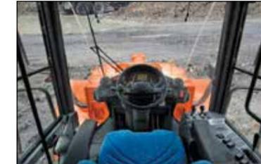
Панорамная кабина дает почти круговую обзорность, чему способствует широкое ветровое стекло и отсутствие задних угловых стоек. Передние колеса всегда находятся в поле зрения оператора, тем самым повышается безопасность и эффективность загрузки.
