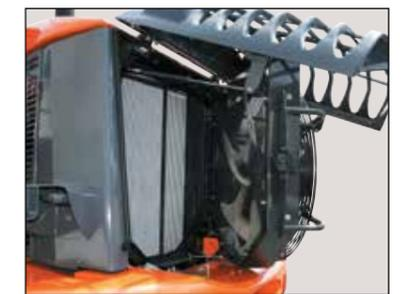
Вращение вентилятора охлаждения с гидравлическим приводом и системой контроля температуры может осуществляться в обратную сторону для легкой очистки радиатора от засорения. Сам вентилятор может быть повернут для обеспечения доступа при очистке.
