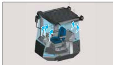
Три дефлектора обдува лобового стекла и два дефлектора обдува заднего стекла предотвращают запотевание стекол, гарантируя беспрепятственный обзор в дождливую и холодную погоду.
