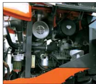
Двойной топливный фильтр с водоотделителем, масляный фильтр двигателя имеют удобное расположение для простоты ежедневной проверки и обслуживания с земли.
