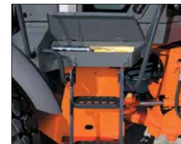
Вместительный ящик для инструментов расположен у верхней ступеньки лестницы на правой стороне погрузчика. В нем может храниться инструмент и шприц для консистентной смазки.
