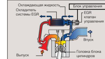
Охлаждаемая система EGR позволяет смешиваться части отработавших газов с воздухом, тем самым снижая концентрацию кислорода в составе воздушной смеси в камере сгорания. Такой механизм позволяет снизить температуру сгорания в цилиндре, тем самым, понижая расход топлива и выброс оксидов азота и увеличивая мощность двигателя. Эта система также понижает температуру выхлопных газов, предотвращая неполное сгорание топлива и уменьшая выброс твердых частиц.
