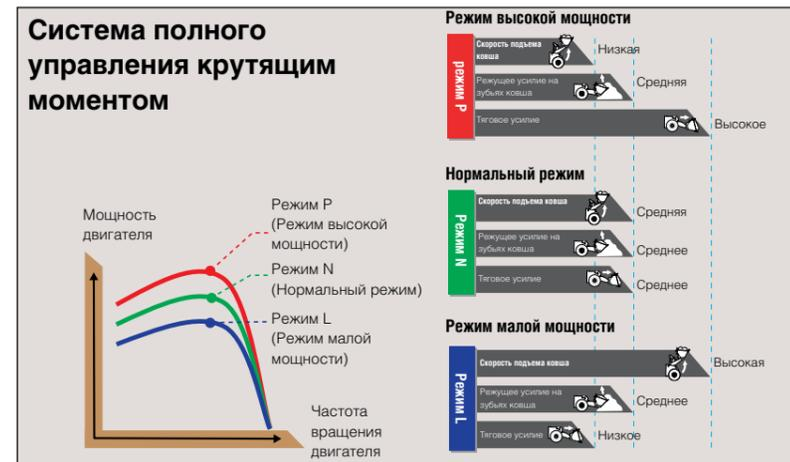
Три режима работы могут быть выбраны в соответствии с предпочтениями оператора и условиями выполняемой работы. В каждом режиме работы система ТТ\* управляет насосом и крутящим моментом двигателя для сбалансированных усилий и скорости операций, согласно требованиям выполняемой работы. Три режима работы могут быть оптимально подобраны для любого разрабатываемого материала с обеспечением высокой производительности.
