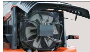
Скорость работы вентилятора может регулироваться в зависимости от температуры жидкости для эффективного охлаждения охлаждающей жидкости, масла системы гидравлики, трансмиссионного масла и масла гидротрансформатора. В результате увеличивается продолжительность службы деталей и снижается расход топлива. Для удобства обслуживания вентиляторы установлены отдельно от двигателя.
