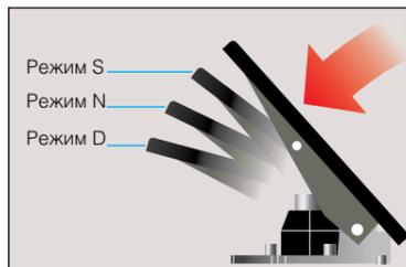
Время отключения муфты сцепления может быть выбрано из трех вариантов для того, чтобы наилучшим образом соответствовать разным условиям работы, включая работу на ровной местности и под уклоном.
