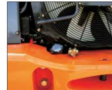
Горловина топливного бака имеет удобное месторасположение, позволяющее вести заправку топлива с земли.
