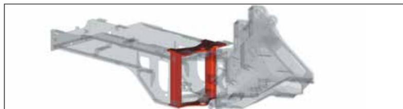
Для увеличения надежности, рама погрузчика с лонжеронами замкнутого профиля была усилена. Центральные балки усиления размещены на большом расстоянии для повышения сопротивления на скручивание.
