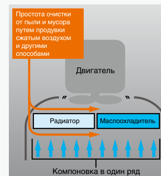
Расположение радиатора и маслоохладителя в один ряд
