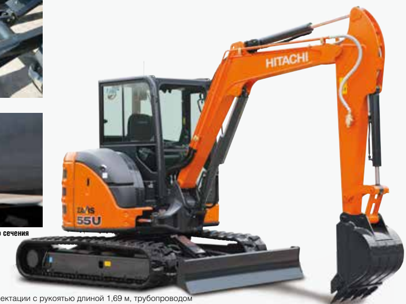
Показан экскаватор в комплектации с рукоятью длиной 1,69 м, трубопроводом для дополнительного навесного оборудования и дополнительным противовесом, поставляемыми в качестве опции.
