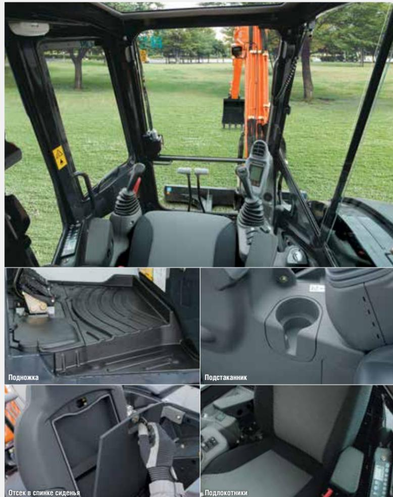
Показан экскаватор в комплектации с кабиной, амортизированным сиденьем, подлокотниками, радиоприемником FM/AM диапазонов, с рычагом управления дополнительным навесным оборудованием и кондиционером, поставляемыми в качестве опции.
