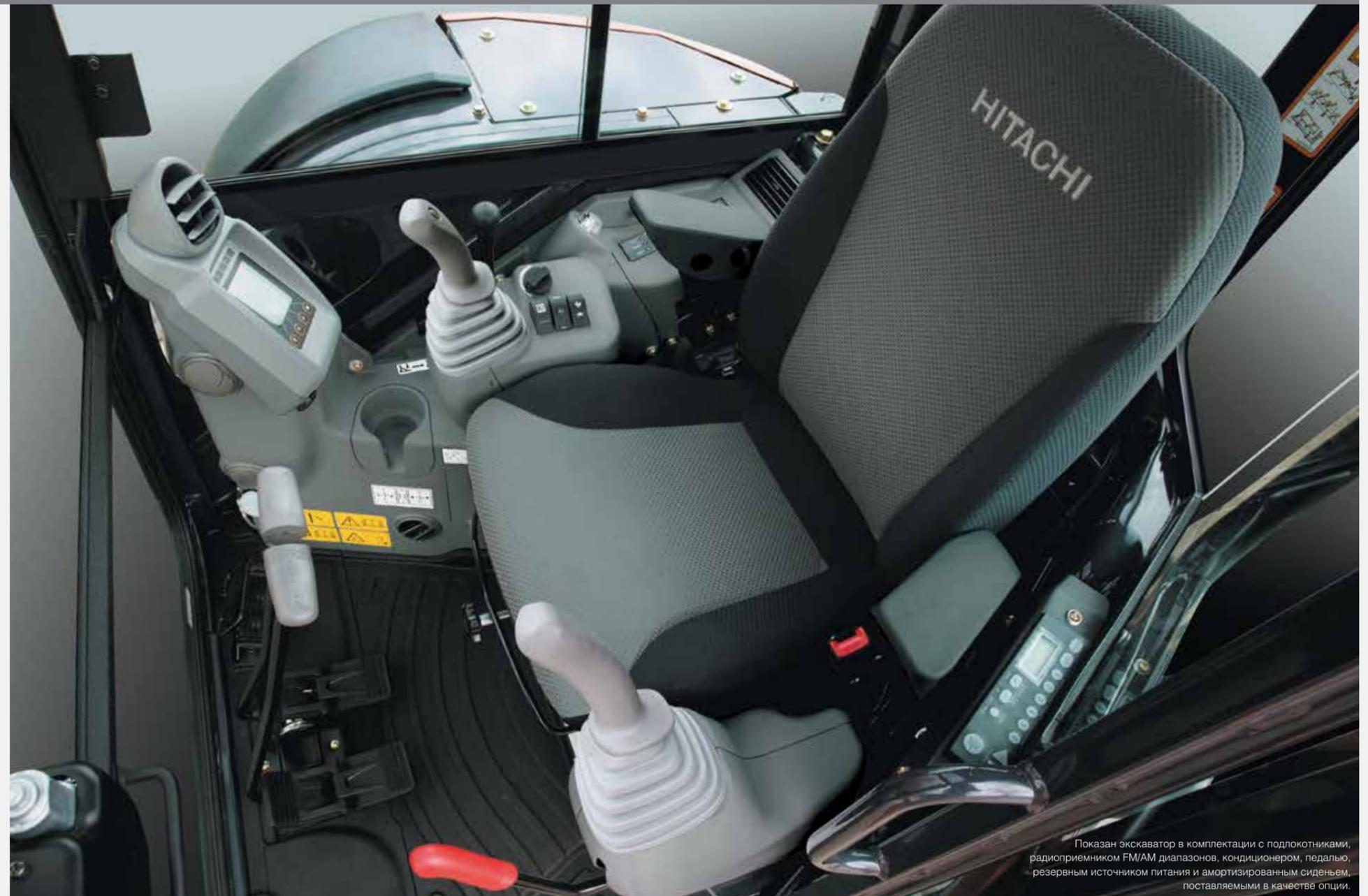
Показан экскаватор в комплектации с подлокотниками, радиоприемником FM/AM диапазонов, кондиционером, педалью, резервным источником питания и амортизированным сиденьем, поставляемыми в качестве опции.
