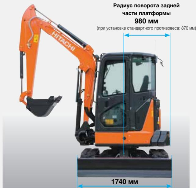
Показан экскаватор в комплектации с рукоятью длиной 1,72 м, трубопроводом для дополнительного навесного оборудования и дополнительным противовесом, поставляемыми в качестве опции.
