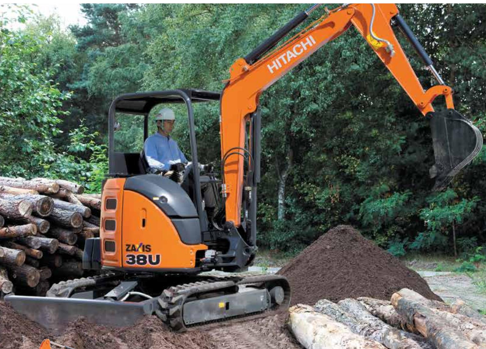
Показан экскаватор в комплектации с рукоятью длиной 1,72 м, дополнительным противовесом, подлокотниками, трубопроводом для дополнительного навесного оборудования и педалью, поставляемыми в качестве опции.
