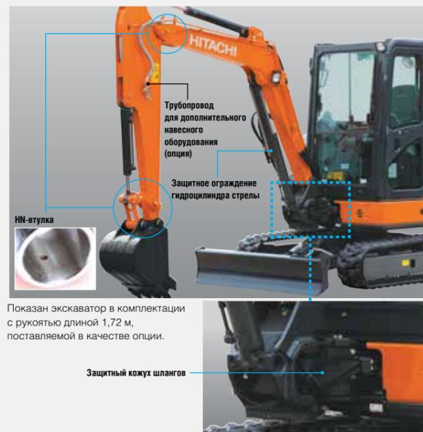
Показан экскаватор в комплектации с рукоятью длиной 1,72 м, поставляемой в качестве опции.
