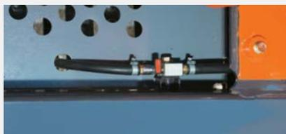
Кран для слива осадка из топливного бака
