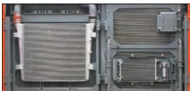
Маслоохладитель и радиатор расположены параллельно, а не последовательно, как в предыдущей модели, что облегчает демонтаж. Такая новая компоновка значительно облегчает чистку пространства вокруг радиатора и маслоохладителя.
