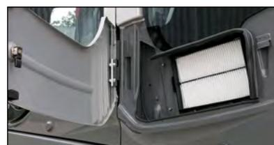
Воздушный фильтр кондиционера для забора свежего воздуха расположен со стороны двери кабины, а не как в предыдущей модели – за креслом оператора. Это позволяет легко чистить и менять воздушный фильтр, а также фильтр системы рециркуляции воздуха в кабине.
