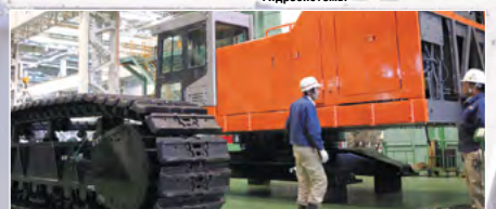
Линия сборки крупных экскаваторов
