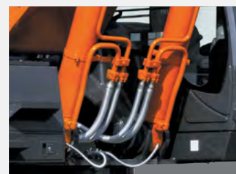
Защита шлангов гидроцилиндров стрелы
