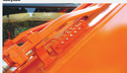
Точки централизованного смазывания шарниров стрелы и рукоятки
