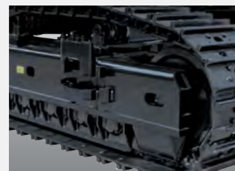
Кронштейны направляющих колес
