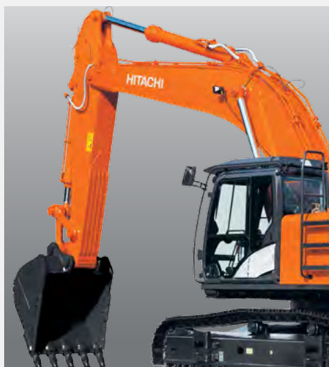
Усиление конструкции стрелы и рукояти при комплектации скальным ковшом
