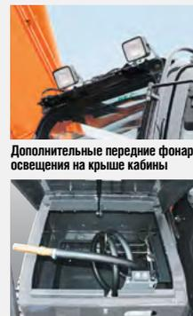
Дополнительные передние фонари освещения на крыше кабины
