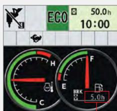
Счетчик моточасов гидромолота
