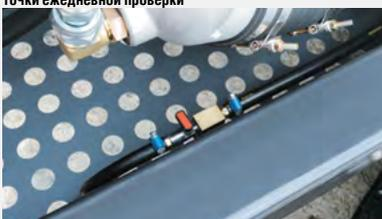
Кран слива отстоя из топливного бака
