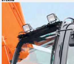
Дополнительные передние фонари освещения на крыше кабины
