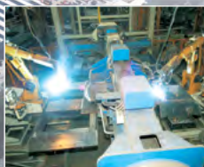
Линия сварки основной рамы
