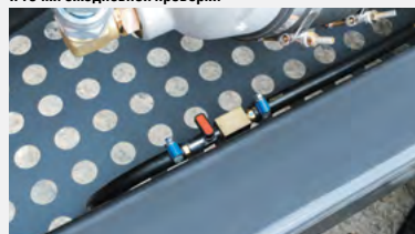
Кран слива отстоя из топливного бака
