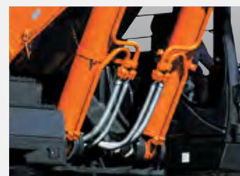
Защита шлангов гидроцилиндров стрелы
