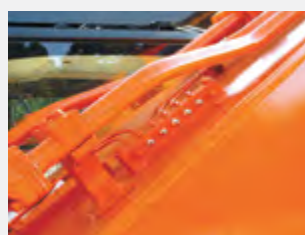
Точки централизованного смазывания шарниров стрелы и рукояти
