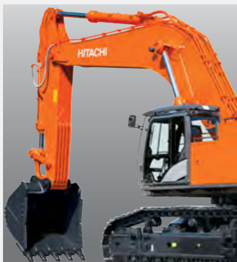
Усиленные стрела и рукоять со скальным ковшом (ZX870H-6 / ZX870LCN-6)
