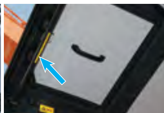
Фиксатор лобового стекла, открываемый одним движением
