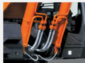
Защита шлангов гидроцилиндров стрелы
