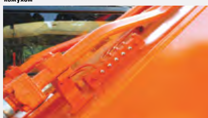
Точки централизованного смазывания шарниров стрелы и рукоятки
