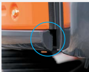
Боковые лонжероны D-образного сечения
