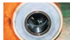
Термическое напыление карбида вольфрама (WC)
