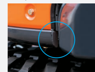
Боковые лонжероны D-образного сечения
