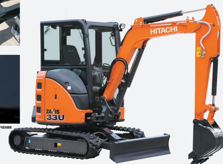
Показан экскаватор в комплектации с рукоятью длиной 1,52 м, кабиной, дополнительным противовесом и трубопроводом для дополнительного навесного оборудования, поставляемыми в качестве опции.
