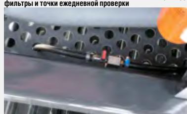
Кран слива отстоя из топливного бака
