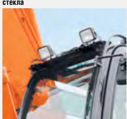
Дополнительные передние фонари освещения на крыше кабины
