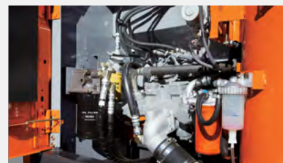
Сгруппированные в одном месте выносные фильтры и точки ежедневной проверки
