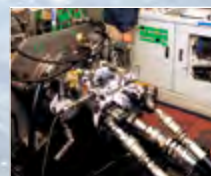
Зона испытания основных насосов гидросистемы
