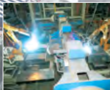
Линия сварки основной рамы
