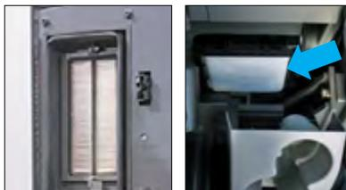
Фильтр приточного воздуха можно легко заменить из кабины, а фильтр циркулирующего воздуха можно заменить, сняв подстаканник.
