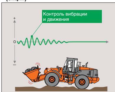
Управление движением позволяет уменьшить горизонтальные и вертикальные колебания во время передвижения по неровному грунту или заснеженной дороге с помощью автоматического управления машиной. Толчки и вибрацию можно в значительной степени погасить, что повышает удобство управления.
