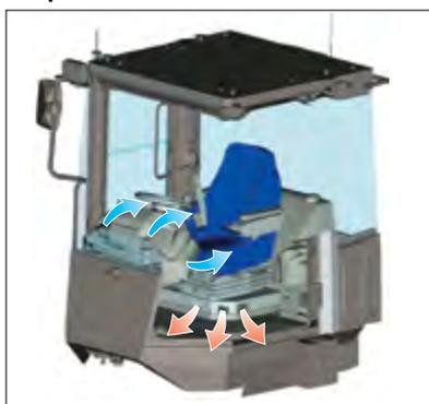
Двухуровневый кондиционер одновременно обеспечивает кондиционирование в области ног и над головой. Направление воздушного потока можно свободно регулировать, а его скорость регулируется автоматически в зависимости от установленной температуры. Герметичная кабина исключает попадание пыли и частиц грунта внутрь кабины даже в пыльных условиях работы.
