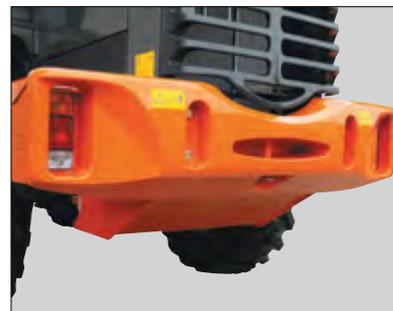
Для защиты топливного бака от столкновения с препятствиями во время работы установлен большой противовес.
