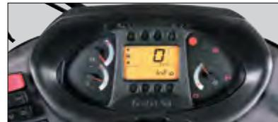
Благодаря легкочитаемому монитору оператор может видеть инструкции по плановому сервисному и техническому обслуживанию.
