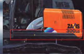
Балки D-образного сечения
