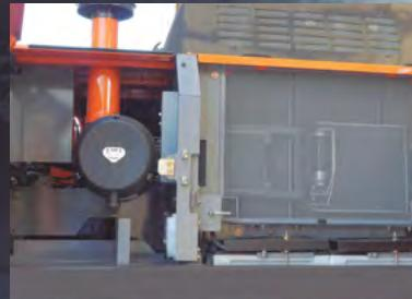
Рама поворотной платформы усиlena балками D-образного сечения, которые обеспечивают повышенную прочность при столкновении с препятствиями.
