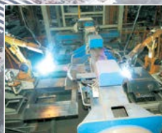
Линия сварки основной рамы
