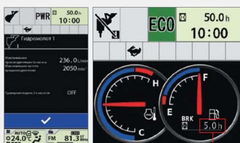
Настройки для гидромолота Счетчик моточасов гидромолота
