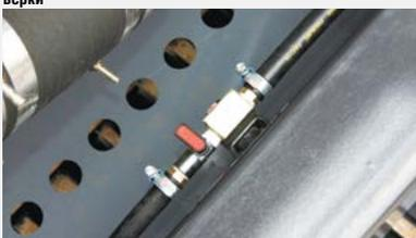
Кран слива отстоя из топливного бака
