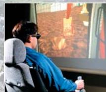
Испытание методом моделирования с сиденья оператора
