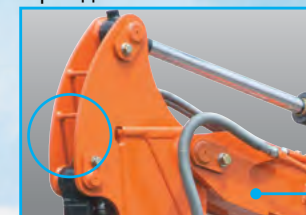
Защитное ограждение гидравлических шлангов Шланг ковша закрыт защитным ограждением во избежание его зацепления и повреждения.
