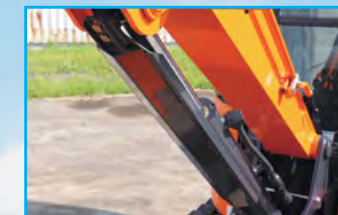
Защитное ограждение гидроцилиндра стрелы Защитное ограждение цилиндра имеет прочную форму в виде перевернутой буквы V.
