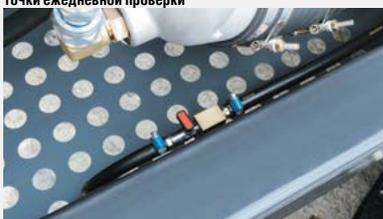
Кран слива отстоя из топливного бака
