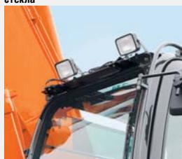
Дополнительные передние фонари освещения на крыше кабины
