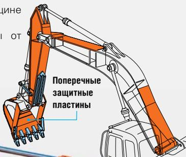
Поперечные защитные пластины
