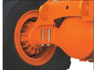
Дисковые тормоза мокрого типа на ступицах колес
