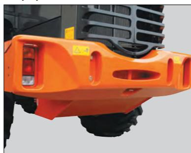
Для защиты топливного бака от столкновения с препятствиями во время работы установлен большой противовес.
