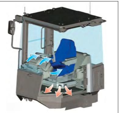
Двухуровневый кондиционер одновременно обеспечивает кондиционирование в области ног и над головой. Направление воздушного потока можно свободно регулировать, а его скорость регулируется автоматически в зависимости от установленной температуры. Герметичная кабина исключает попадание пыли и частиц грунта внутрь кабины даже в пыльных условиях работы.
