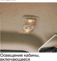
Освещение кабины, включающееся при открытии двери
