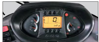
Благодаря легочитаемому монитору оператор может видеть инструкции по плановому сервисному и техническому обслуживанию.
