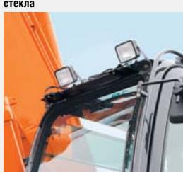
Дополнительные передние фонари освещения на крыше кабины
