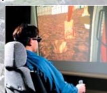
Испытание методом моделирования с сиденья оператора
