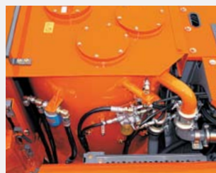
Фильтры на стенке центрального прохода
