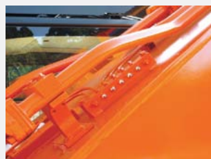
Точки централизованного смазывания шарниров стрелы и рукояти
