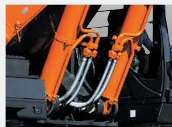
Защита шлангов гидроцилиндров стрелы
