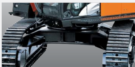
Конструкция ходовой части
