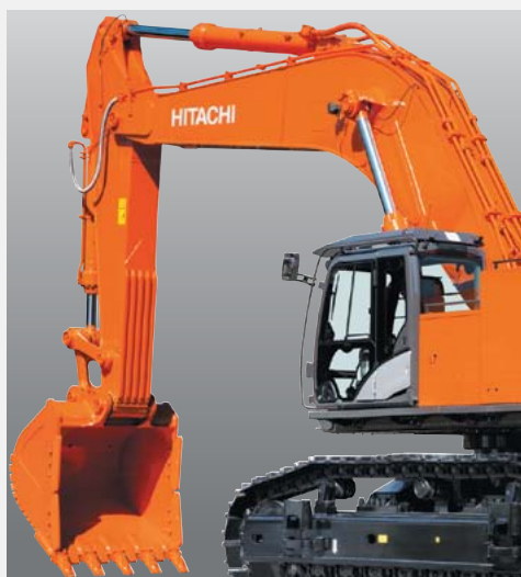
Усиленные стрела и рукоять со скальным ковшом (ZX870H-56 / ZX870LCN-56)
