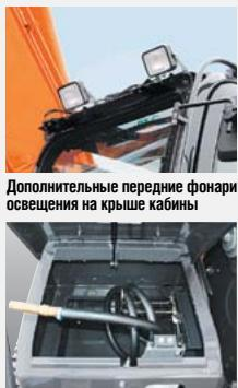
Дополнительные передние фонари освещения на крыше кабины
