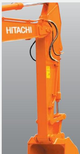
Основные трубопроводы для дополнительного рабочего оборудования
