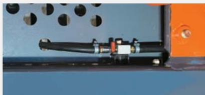
Кран для слива осадка из топливного бака
