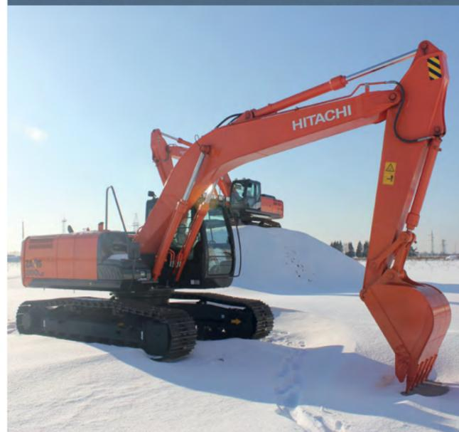
**З**аводская спецификация для суровых климатических условий, разработанная для гусеничных экскаваторов Hitachi моделей ZX200, ZX240, ZX280 и ZX330-5G, позволяет технике выдерживать температуру от  $-40^{\circ}\text{C}$  до  $+40^{\circ}\text{C}$ .
