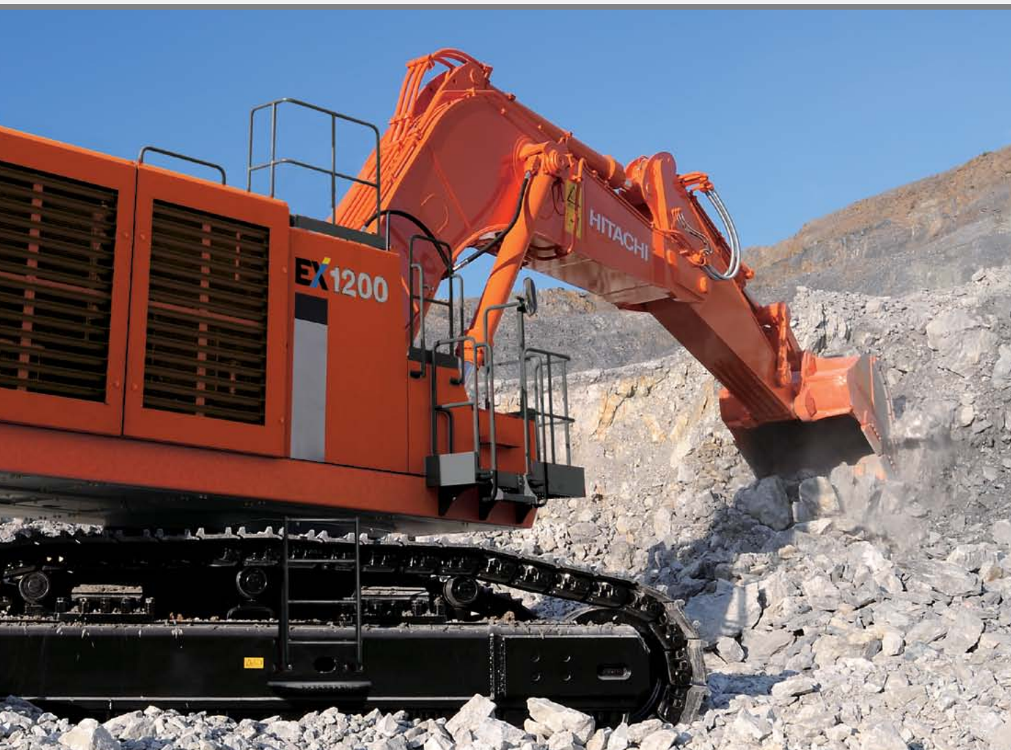
Примечание: Эта фотография включает специально разработанные компоненты, в том числе укрепленные пластины для боковой рамы.
